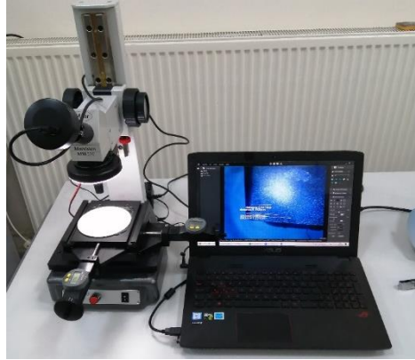
Şekil 1. Takım aşınması ölçüm sisteminin hazırlanması
