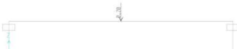
Şekil 17. Ankastre Mesnete Etkitilen Tekil Yük (200kg)
