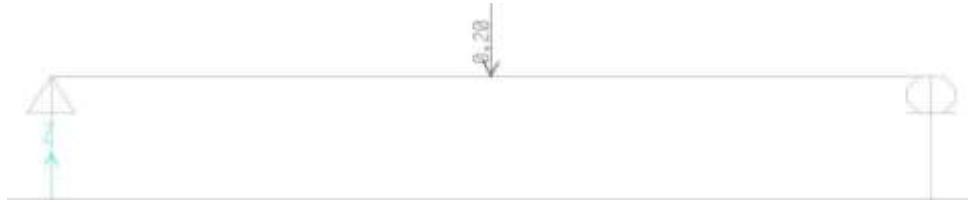
Şekil 14. Sabit Mesnete Etkitilen Tekil Yük (200kg)
