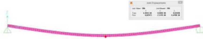
Şekil 23. Tekil Yükleme Sonlu Elemanlar Sabit Mesnet Deplasman Grafiği
