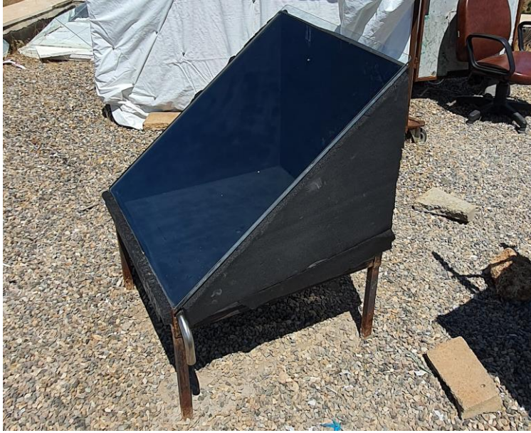
Şekil 1. Tek eğimli güneş enerjili damıtıcı
