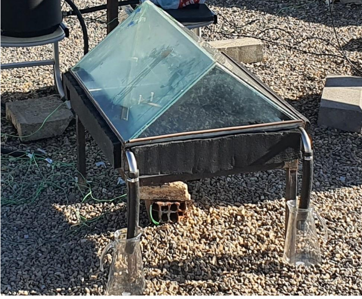
Şekil 2. Çift eğimli güneş enerjili damıtıcı
